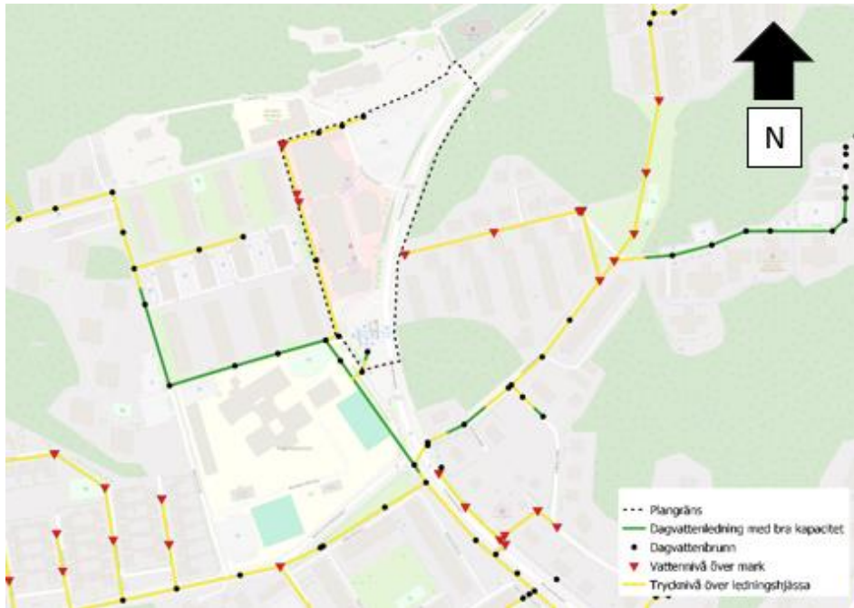
Figur 16. Ledningssystem i och kring planområdet. Planområdets ungefärliga gräns markerat. Grön triangel indikerar under hjässa, gul triangel indikerar över hjässa och röd triangel indikerar över mark (VA-banken 2023).
