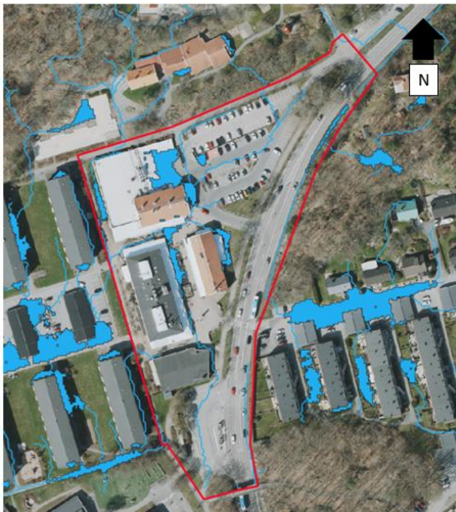
Figur 23. Avrinningsvägar och låga punkter enligt befintlig höjdsättning. Planområdets ungefärliga gräns markerat. (Scalgo Live 2024).
